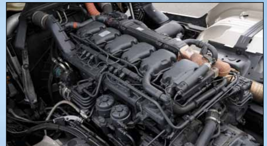
Il propulsore è un 13 litri Euro 5 da 480 cavalli, con il ricircolo dei gas di scarico (EGR) ed iniezione del carburante ad altissima pressione (2.400 bar).
