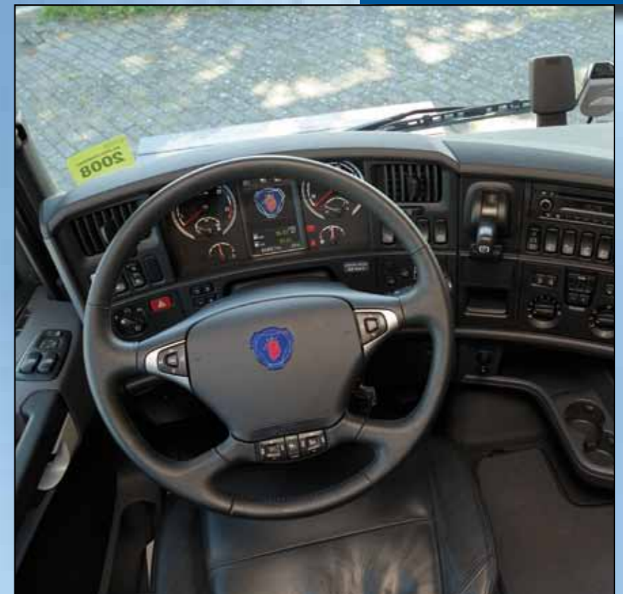
Il cruscotto mostra una strumentazione ben visibile e completa, dove è possibile impostare "due campi programmabili" a nostro piacimento che il display dovrà visualizzare.
