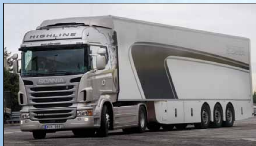
Le nuove minigonne/deflettori laterali che consentono di risparmiare carburante in ragione di circa lo 0,4-0,5 percentuale.
