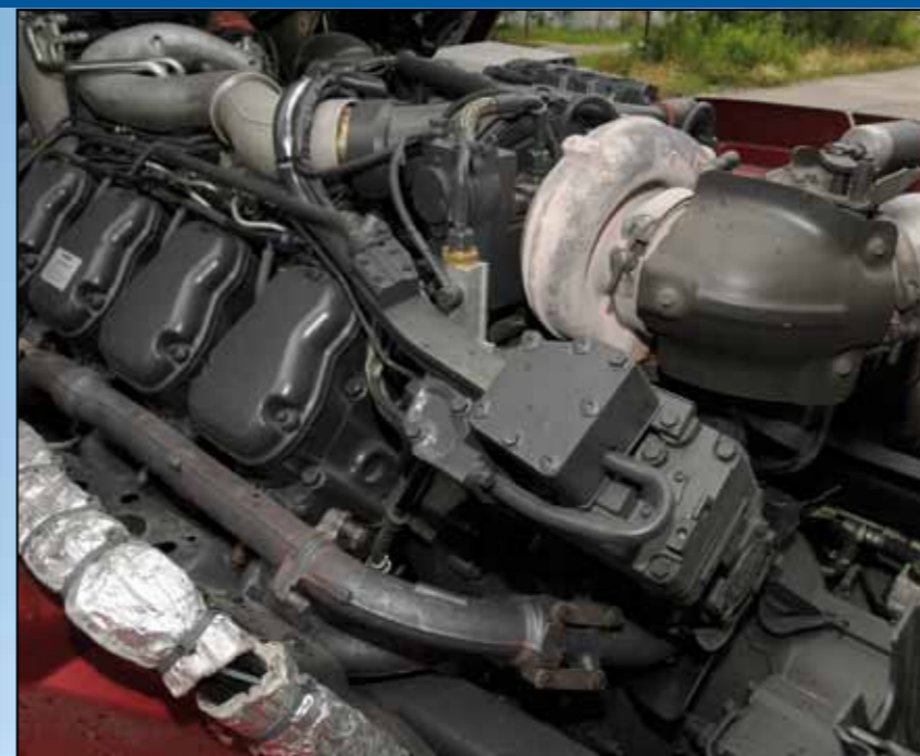
Raggiungere una potenza del genere (730 Cv) è stato possibile innalzando la cilindrata totale a 16,4 litri ed equipaggiando l'iniezione con il sistema ad alta pressione XPI (2.400 bar).
